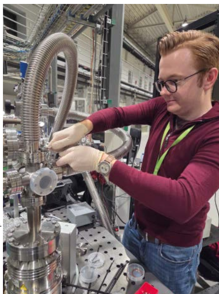
Instalacja pompy turbomolekularnej
