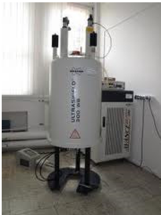
Spektrometr NMR firmy BRUKER_Avance III 300 z magnesem nadprzewodzącym 7 T w pracowni MRJ w budynku IF UJ przy Reymonta 4.
