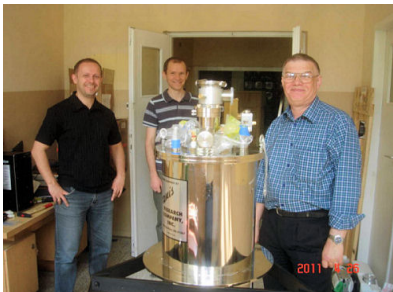
Aparatura mössbauerowska z magnesem nadprzewodzącym 9 T w trakcie montażu w pracowni EM w budynku IF UJ przy ulicy Reymonta 4. ATOMIN – 2011. Od lewej do prawej stoją : Jacek Gurgul, Tomasz Malarz i Kazimierz Łątka.
