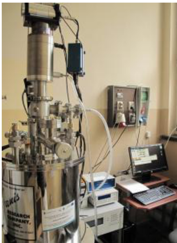
Aparatura mössbauerowska z magnesem nadprzewodzącym w pracowni EM w budynku IF UJ przy ulicy Reymonta 4. ATOMIN – 2011.
