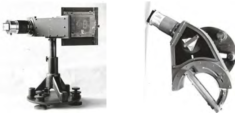
Fot. 7 Spektrograf kwarcowy bardzo wysokiej świetlności. Widok ogólny i widok wnętrza spektrografu.
