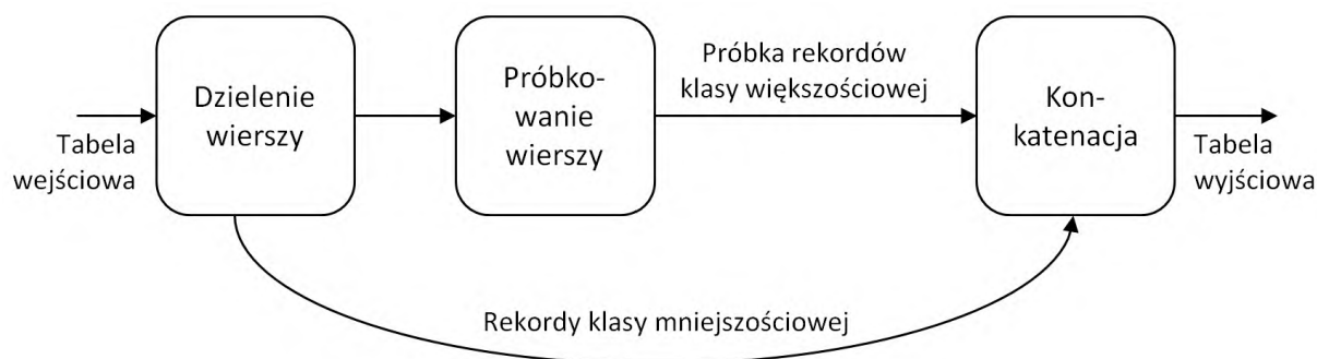
Rysunek 4.1: Diagram przepływu narzędzia DePress przeciwdziałający zjawisku niezbalansowania klas
