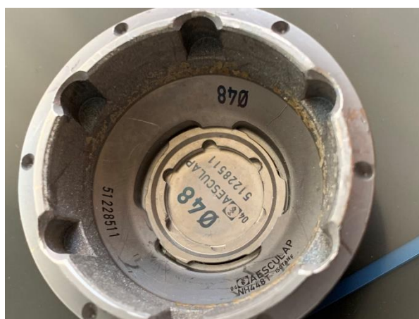
Rys. 28. Panewka wykorzystana do badania firmy Aesculap – typu Screw Socket S.C. – NH448T o średnicy 48mm - ISOTANF – stop typu (Ti 6 Al 4 V / zgodnie z normą ISO 5832-3 3 oraz ASTM F 136 4 )
