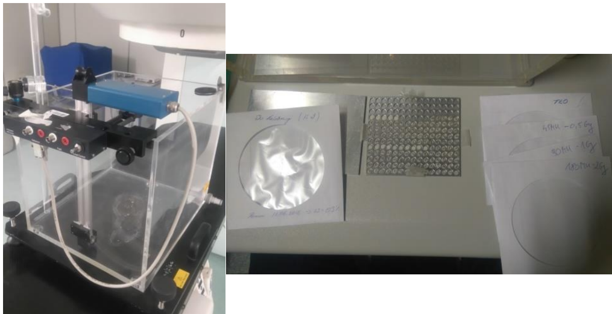
Rys. 26. Fantom wodny wykorzystywany do zmierzenia wydajności aparatu terapeutycznego, oraz detektory termoluminescencyjne przygotowane po pomiarze do odczytu wraz z detektorami, które posłużyły do kalibracji dawki, zapakowanymi w odpowiednie dla danej dawki koperty.
