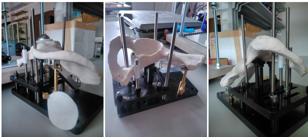
Rys. 19. Statyw unieruchamiający pod połowę miednicy, dzięki któremu możliwe były mechaniczne zmiany, korekty w wyglądzie wykorzystanego do badania materiału. Dzięki zastosowaniu wielu regulowanych elementów możliwe było dopasowanie kształtu statywu zarówno do kości zwierzęce jak i sztucznych.
