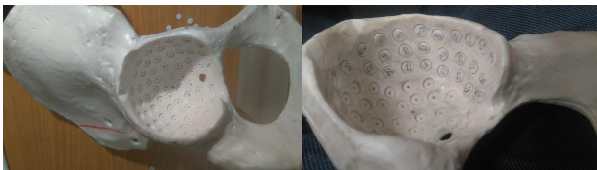
Rys. 20. Widok na panewkę stawu biodrowego w sztucznej kości z wykonanymi odwiertami na gniazda detektorów TL oraz widok umiejscowionych detektorów.
