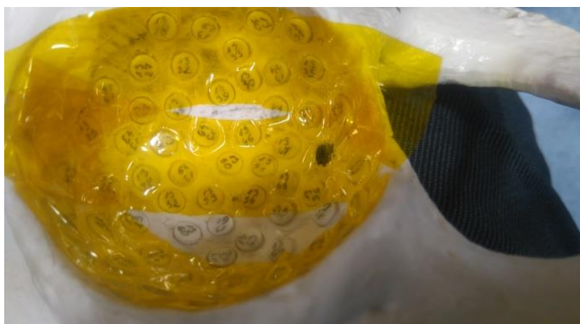
Rys. 23. Widok zabezpieczonych taśmą kaptonową detektorów TL zaaplikowanych w odpowiednie dla nich gniazda w sztucznej kości
