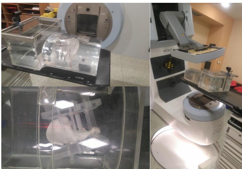
Rys. 25. Widok fantomu pomiarowego wypełnionego wodą, z umieszczoną w jego wnętrzu, w statywie, sztuczną kością wraz detektorami TL oraz enedoprotezą. Zdjęcia wykonano przy różnych kątach gantry aparatu terapeutycznego, w trakcie sprawdzania możliwości wystąpienia kolizji
