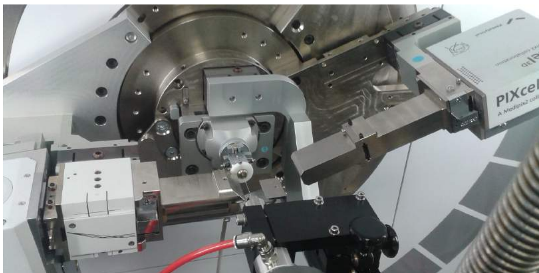
Rys. 3.1. Konfiguracja pomiarowa dyfraktometru Empyrean 2.
