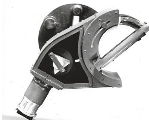
Il. 4. Spektrograf zbudowany przez Andrzeja Kisiela używany w jego pracy doktorskiej w latach 1952-1955 (widok z boku i wnętrza z góry). Obejmował on zakres widmowy 1850 - 2500 Å. Fot. A. Kisiel
