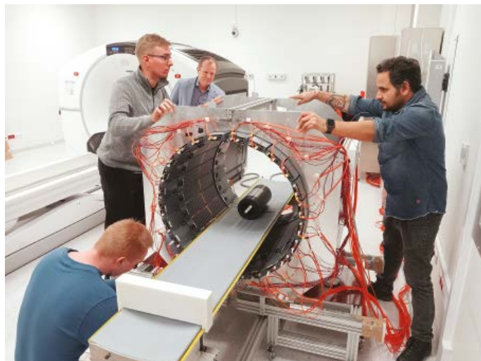
Naukowiec podczas wykonywania pomiarów fantomowych tomografem J-PET
