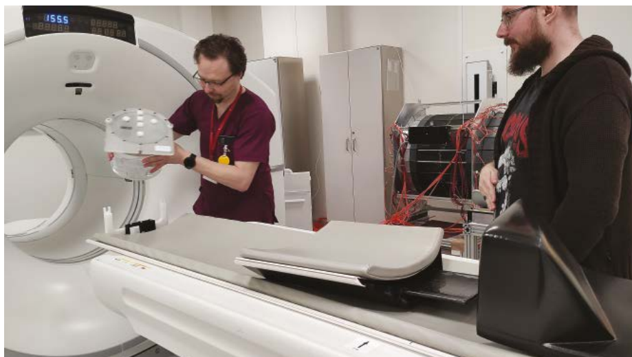
Analiza fantomu Jaszczaka za pomocą klinicznego tomografu PET; od lewej: mgr inż. Bogusław Głowa i dr Szymon Niedźwiecki
