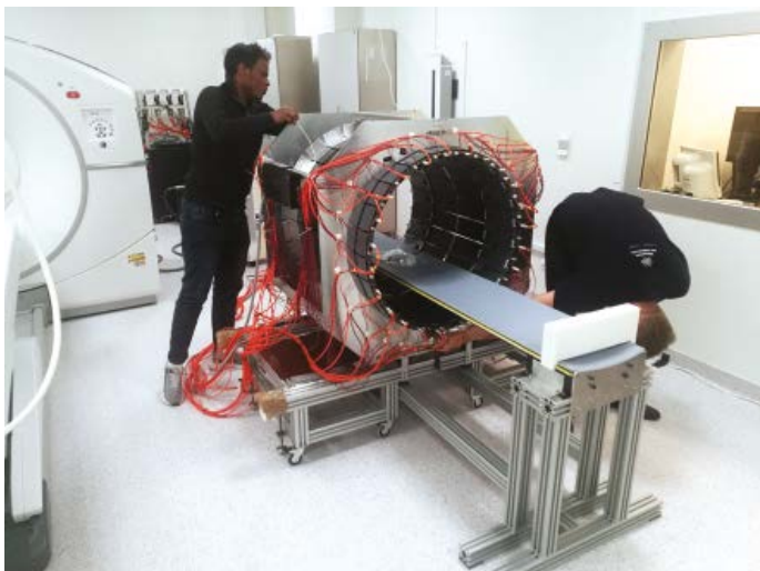
Naukowiec podczas wykonywania pomiarów fantomowych tomografem J-PET
