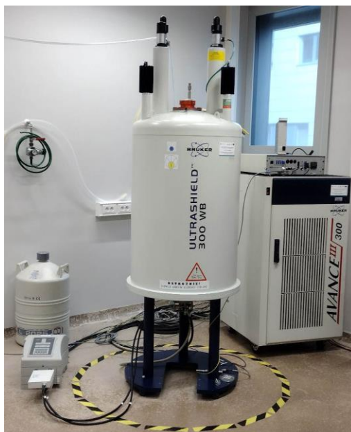
Rysunek 26. Spektrometr Bruker Avance III 300 w laboratorium NMR Zakładu Fizyki Medycznej IF UJ.
