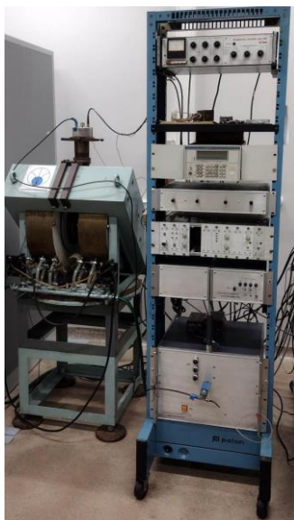
Rysunek 27. Relaksometr impulsowy WNS HB65 firmy Waterloo NMR Spectrometers, Waterloo, Ontario, Kanada w Zakładzie Fizyki Medycznej IF UJ.
