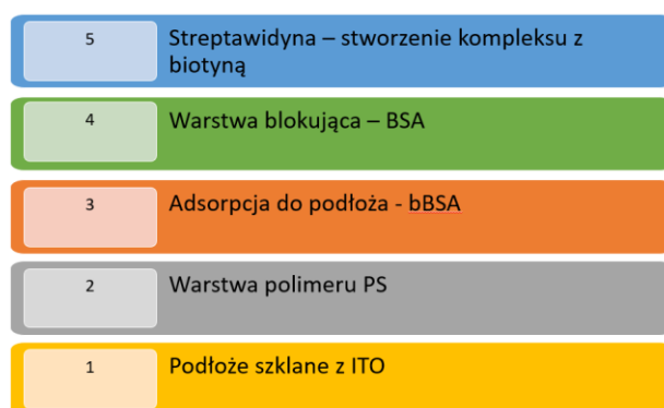
Rysunek 66 Schemat tworzenia próbki do pomiarów ToF-SIMS wraz z kolejnością nakładanych warstw (1-5)
