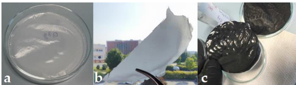
Rys. 20 Przykładowe wytworzone warstwy polimeru PCL: polimer (a), PCL:5CB 10:1 (b), PCL:SWCN 10:0,5 (c).
