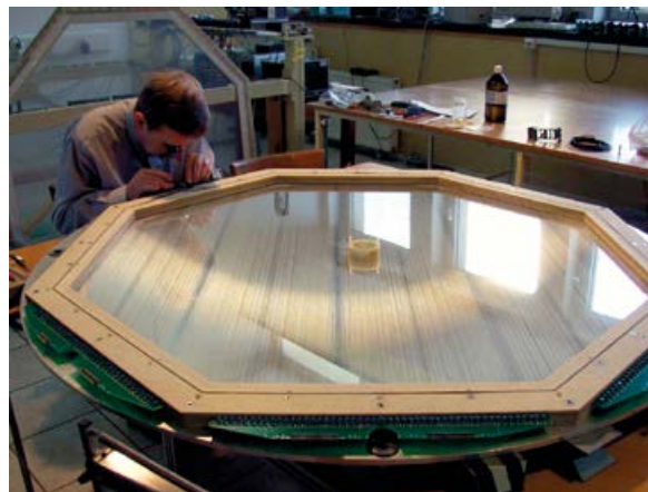
Zakład Fizyki Jądrowej wyspecjalizował się w budowie wyrafinowanych komór dryfowych. Tu właśnie pokazana jest taka komora podczas jej montażu, który wykonuje inż. Andrzej Misiak
