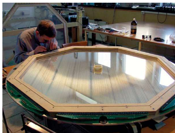
Zakład Fizyki Jądrowej wyspecjalizował się w budowie wyrafinowanych komór dryfowych. Tu właśnie pokazana jest taka komora podczas jej montażu, który wykonuje inż. Andrzej Misiak.
