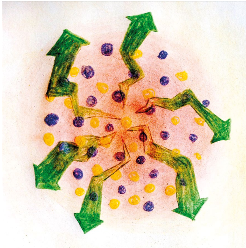
Szkic atomowego lasera przypadkowego. Nieporządek selekcjonuje fale materii, które są emitowane z ośrodka (rysunek Ola Sacha)
