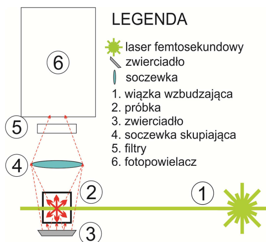
Rys.11 Schemat aparatury do czasowo rozdzielczej detekcji fosforescencji tlenu singletowego przy 1270nm. Wiązka lasera (1) padająca na próbkę prowadzi do wzbudzenia fotosensybilizatora (2). Wzbudzony fotosensybilizator może przekazać swoją energię wzbudzenia na rozpuszczony w roztworze tlen, co z kolei prowadzi do wygenerowania tlenu singletowego. Pomiaru fosforescencji ^1\text{O}_2 dokonuje się pod kątem 90^\circ w stosunku do wiązki wzbudzającej promieniowania laserowego po uprzednim skupieniu sygnału za pomocą soczewki (4) na oknie fotopowielacza (6) oraz przepuszczeniu przez odpowiednie filtry (filtr odcinający promieniowanie poniżej 1100nm oraz filtr interferencyjny wąskopasmowy z maksimum transmitancji około 1270nm (5)). W celu zwiększenia intensywności rejestrowanego sygnału zastosowano zwierciadło (3) odbijające fotogenerowane fotony w kierunku fotopowielacza.
