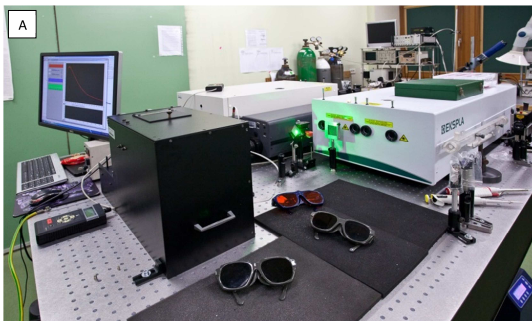
Rys.13 (A) System 2 do detekcji fosforescencji tlenu singletowego w 1270nm. Wiązka lasera nie wymaga stosowania dodatkowych filtrów w celu otrzymania pożądanej długości fali. (B) Schemat układu detekcji luminescencji w podczerwieni skonstruowany na wzór układu z Systemu (I).
