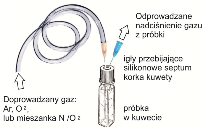
Rys.17 Schemat układu do przedmuchiwania próbki gazem/mieszaną gazową. Gaz (z butli) doprowadzony jest wężykiem tygonowym zakończonym igłą do próbki. Druga igła służy do wyrównania ciśnienia nad roztworem.
