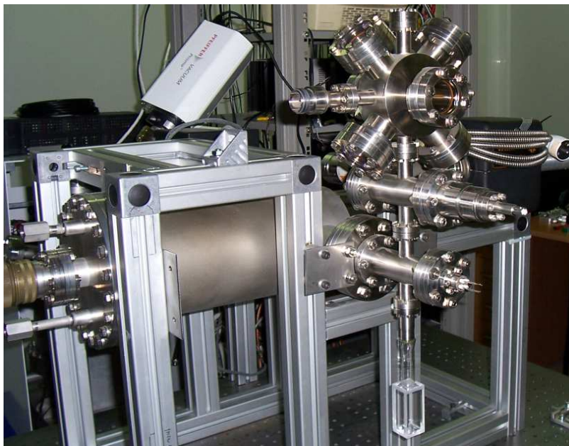
Rys. 3.3: Zdjęcie układu próżniowego wykonane tuż po złożeniu. W sekcji górnej znajduje się komora górnej pułapki MOT1. W dolnej części widoczna komórka kwarcowa, w której wytwarzana jest dolna pułapka MOT2, pułapka magnetyczna MT oraz kondensat BE.
