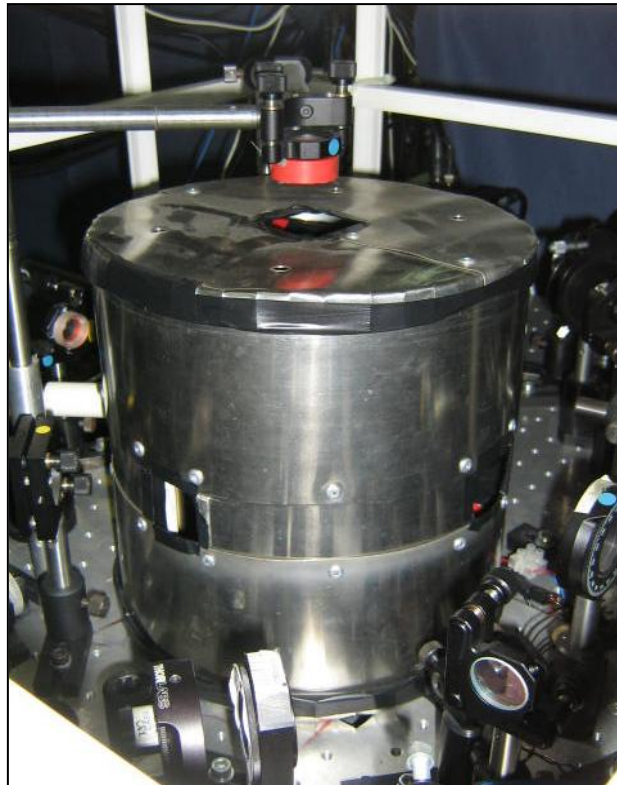
Rysunek 25. Ekran magnetyczny izolujący komorę próżniową eksperymentu od zewnętrznych pól magnetycznych.
