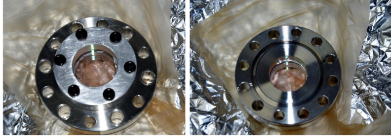
Rysunek 4.10. Okienka po zamontowaniu na indowych uszczelkach do zmodyfikowanych flansz próżniowych
