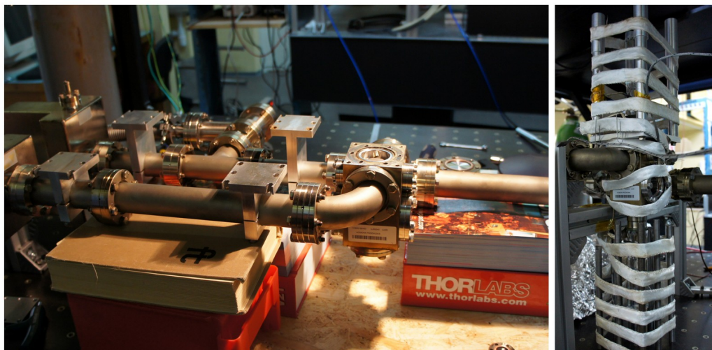
Rysunek 2.5. Przygotowanie komórek szklanych do procesu wygrzewania. Po lewej zdjęcia aparatury przygotowanej do podwieszenia i dołączenia komórek szklanych. Po prawej instalacja pasów grzewczych na słupkach chroniących komórki szklane dołączone do reszty aparatury.
