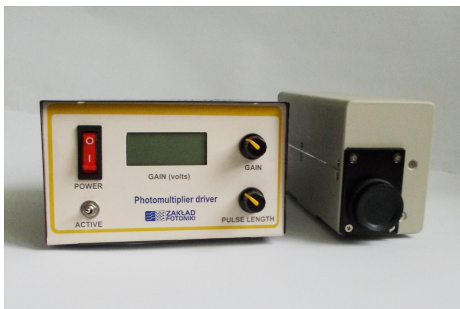
Rys. C.2. Moduł fotopowielacza wraz z układem zasilania, sterowania i bramkowania wykonanym przez autora pracy.
